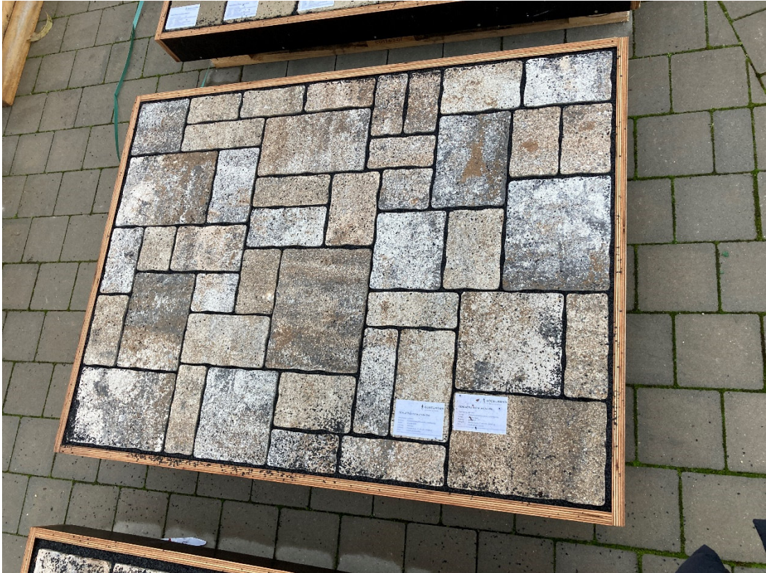
Abbildung 13: Appia-Stone nativo, scharfkantig, Muschelkalk, Kleinpflastersystem 8 cm, 9 Formate im wilden Verband
